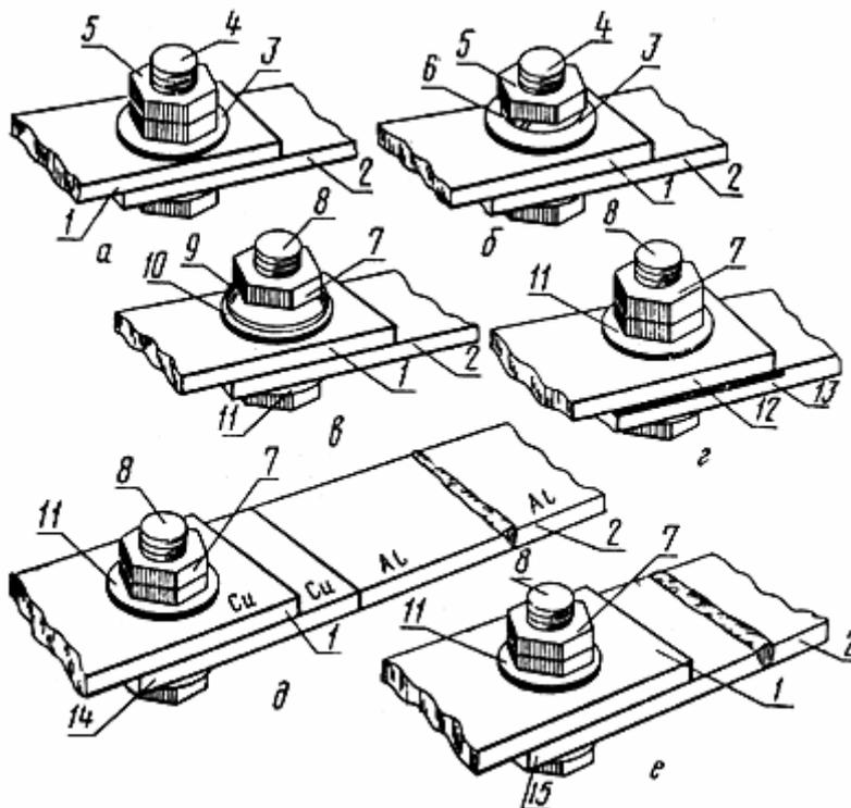
а - крепежом из цветного металла с контргайкой; б - крепежом из цветного металла с пружинной шайбой; в - стальным крепежом с тарельчатой пружиной; г - стальным крепежом с защитными металлическими покрытиями рабочих поверхностей с контргайкой (пружинной шайбой); д - стальным крепежом через переходную медно-алюминиевую пластину с контргайкой (пружинной шайбой); е - стальным крепежом через переходную пластину из твердого алюминиевого сплава с контргайкой (пружинной шайбой)
