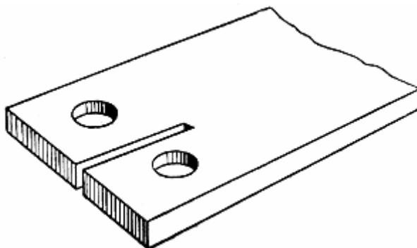
1. Контакт-детали, имеющие два и более отверстий под болты в поперечном ряду, рекомендуется выполнять с продольными разрезами, как показано на чертеже.
