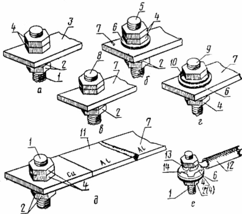
а - проводник из меди, твердого алюминиевого сплава или алюминия с защитным металлическим покрытием рабочей поверхности; б, в, г - алюминиевый проводник;
