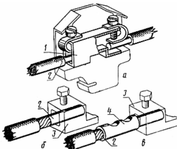
а, б - однопроволочная (многопроволочная, сплавленная в монолит) жила;
