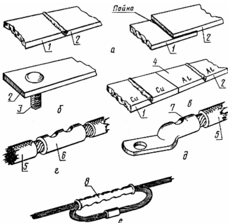
а - сваркой или пайкой; б - со штыревым выводом сваркой; в - сваркой через переходную медно-алюминиевую пластину; г - соединение жил проводов (кабелей) через соединительную гильзу опрессовкой; д - соединение жилы провода (кабеля) с кабельным наконечником опрессовкой (сваркой, пайкой); е - соединение жил проводов в овальных соединителях.
